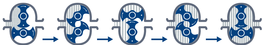
两叶转子工作原理图 Bi-wing rotors diagram
